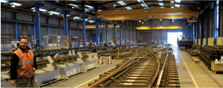
FERTIG MONTIERTE METRO-WEICHE BEREIT ZUR ABNAHME IM HERSTELLERWERK
